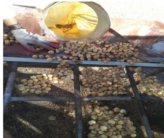
شکل ۴. اشفنگ سیار طراحی شده دو منظوره
