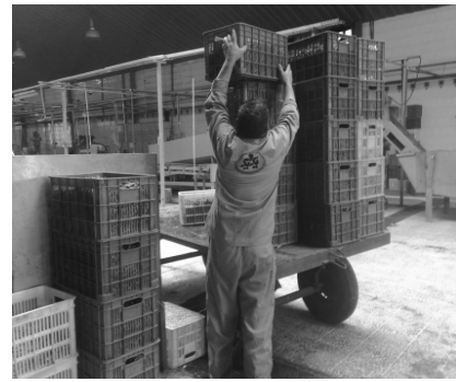
شکل ۱: وضعیت نامناسب اپراتور واحد تخلیه بار
