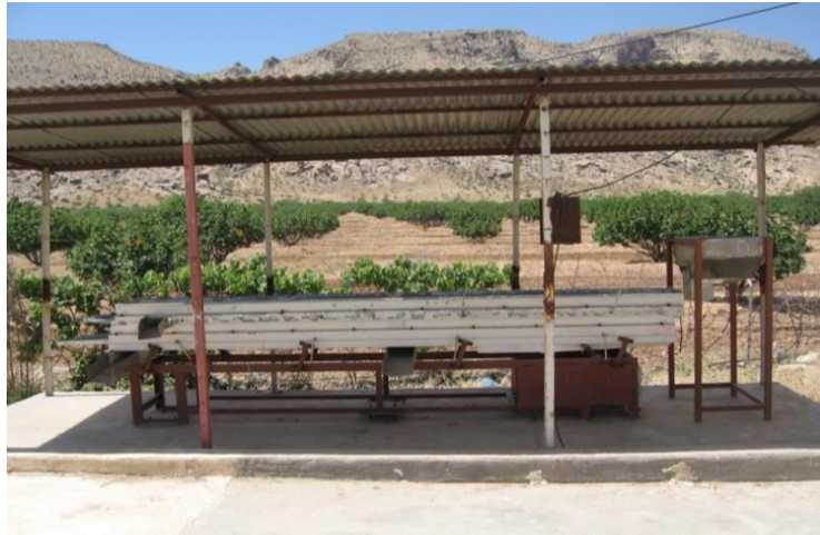
شکل ۵. دستگاه سورت با صفحه مشبک.
