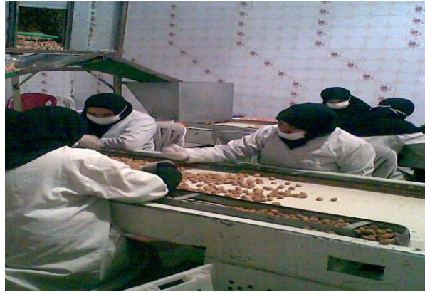
شکل ۲. جداسازی و درجه‌بندی انجیر روی نوار نقاله
