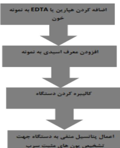
شکل ۳- مراحل آماده سازی نمونه جهت بررسی با روش ASV (۱۶)
