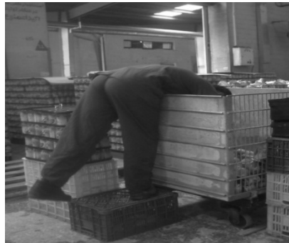
شکل ۳: وضعیت نامناسب اپراتور سبد اتوکلاو
