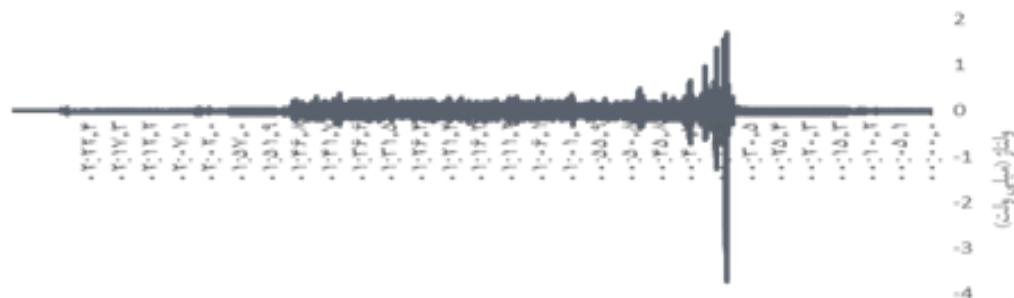
شکل ۲: فعالیت الکتریکی عضله پهن داخلی کاربران در حین کلاچ‌گیری تراکتور MF285
