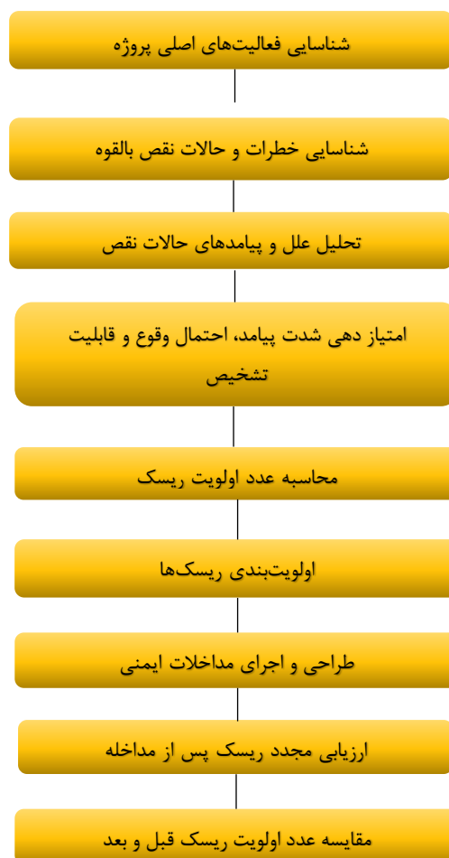
شکل ۱: مراحل اجرای ارزیابی ریسک و بررسی اثربخشی مداخلات ایمنی در پروژه ساخت‌وساز فولادی با استفاده از روش FMEA
