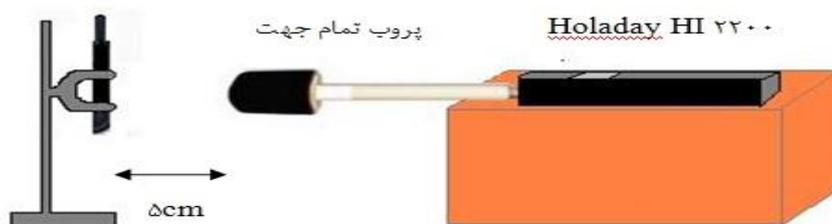
شکل ۱: طرح شماتیک روش اندازه‌گیری امواج مایکروویو تلفن‌های همراه مطابق با روش استاندارد C95.3
