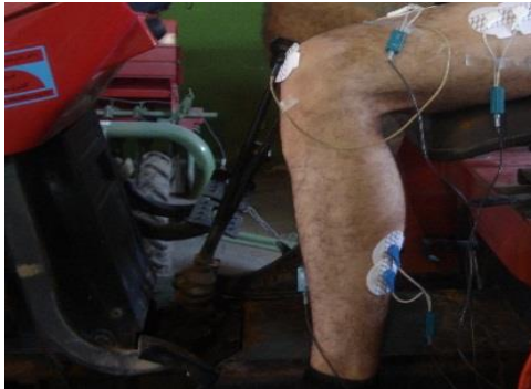
شکل ۱: محل الکتروگذارای عضلات منتخب پای کاربران تراکتور
