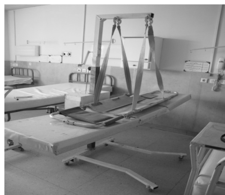
شکل ۱: نمایی از برانکاردار ارگونومیک طراحی شده
